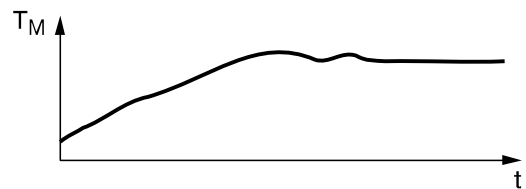
Abb. 6.4 Komparator und Dämpfung eingeschaltet
