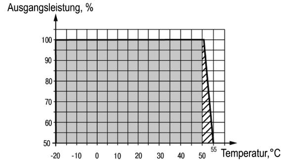
Abb. 1 Ausgangsleistung vs. Umgebungstemperatur
