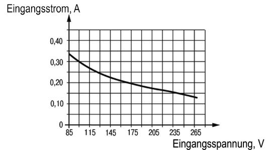
Abb. 3 Eingangsstrom vs. Eingangsspannung
