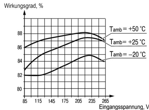
Abb. 4 Wirkungsgrad vs. Eingangsspannung und Umgebungstemperatur
