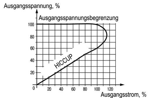
Abb. 2 Ausgangsspannung vs. Ausgangsstrom
