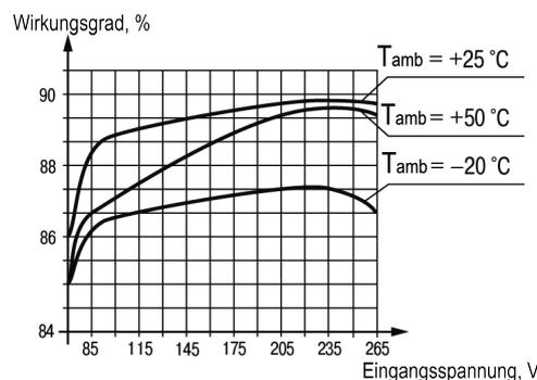
Abb. 4 Wirkungsgrad vs. Eingangsspannung und Umgebungstemperatur
