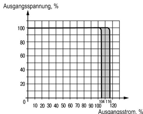
Abb. 2 Ausgangsspannung vs. Ausgangsstrom
