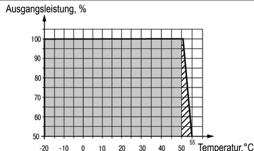
Abb. 1 Ausgangsleistung vs. Umgebungstemperatur
