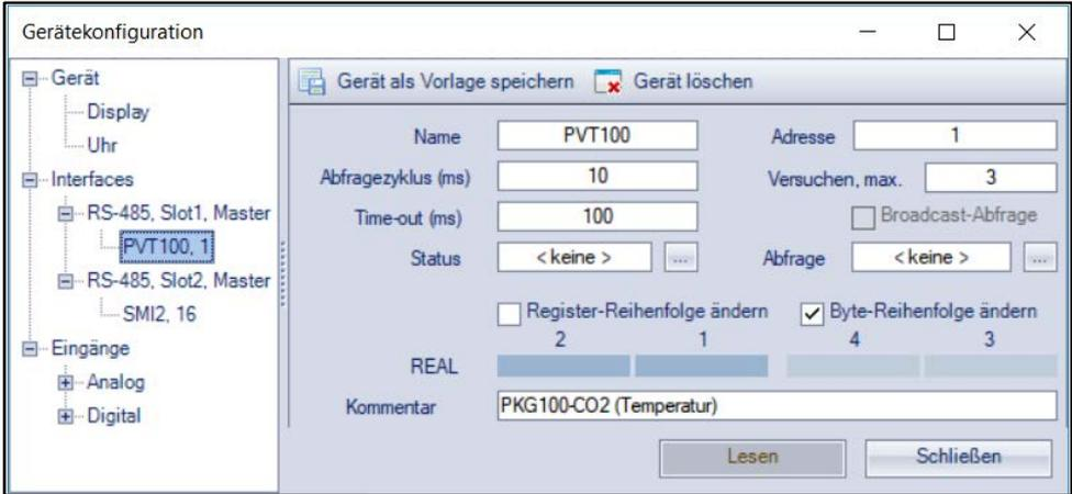
Anschließend erfolgt die Konfiguration der RS485 Anzeige SMI2. Die Anzeige ist über den RS485 Slot 2 mit dem PR200 verbunden.
