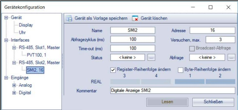
Im Lieferzustand vom PR200 ist die RS485-Netzwerkschnittstelle auf Slave eingestellt. Um die Schnittstelle als Master verwenden zu können, erfolgt die Einstellung der Jumperpositionen gemäß PR200-Bedienungsanleitung Seite 10, Abb. 4.2 a.
